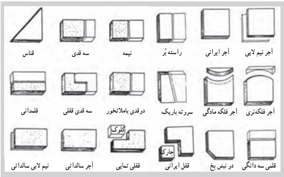
۱۳-۶- اجزای آجر و انواع تراش‌های روی آن
