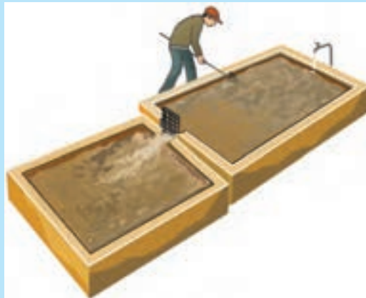
تهیه‌ی آهک شکفته به روش تر (دوغابی)
