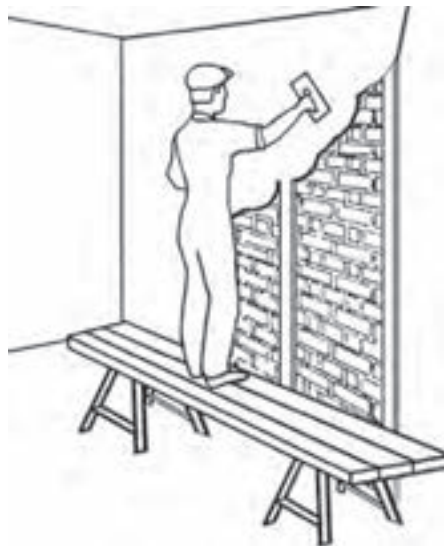
شکل ۵-۸- طریقه‌ی گچ کاری دیوار
