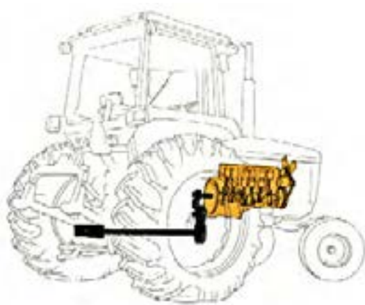
شکل ۳۲-۵ تراکتورها می‌توانند توان موجود روی میل لنگ را به توان محور تواندهی تبدیل کنند.
