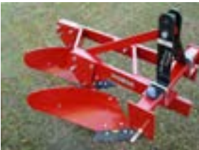
شکل ۳-۵- انواع گاو آهن برگرداندار از نظر تعداد خیش
