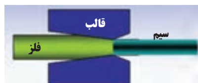
شکل ۳-۲۵ تولید سیم به روش کشش
