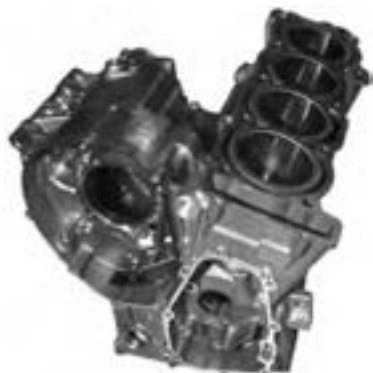
شکل ۱۹-۳ بدنه موتور
