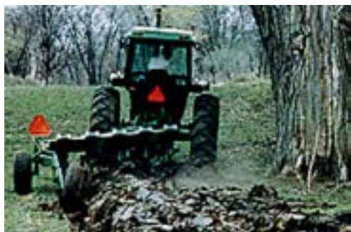
شکل ۷-۵- سرعت شخم زدن ۴ تا ۶ کیلومتر در ساعت است.
