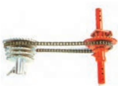
شکل ۱۱-۸ — زنجیر و چرخ زنجیر سیستم محرک موزع
