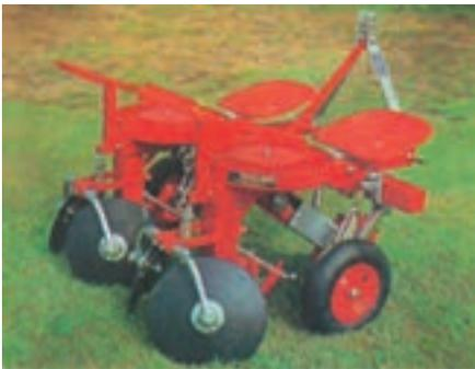
— سکو و صندلی: در غده کارهای نیمه خودکار، برای پر کردن موزع و بررسی کار دستگاه، صندلی یا سکویی برای قرار گرفتن کارگر در روی دستگاه تعبیه می‌گردد.
