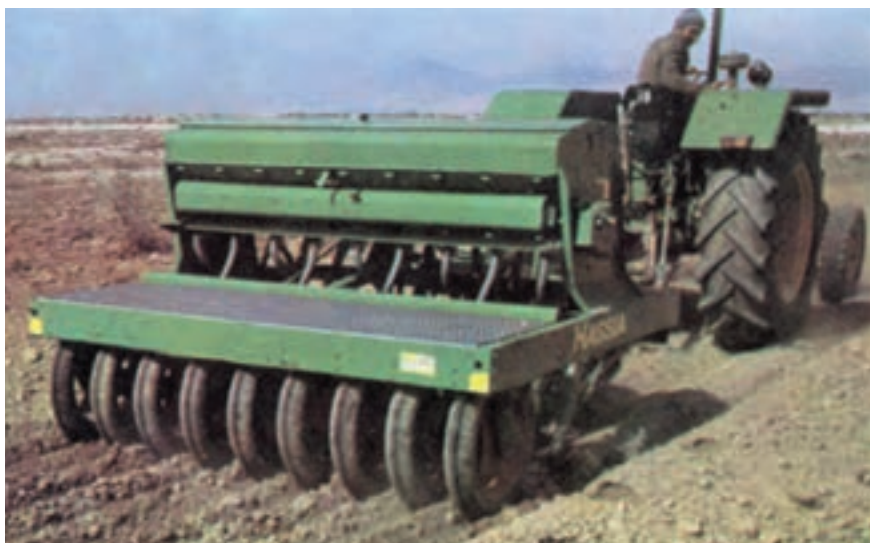
شکل ۶-۱– خطی کار با چرخهای فشاردهنده (مناسب برای دیمکاری)
