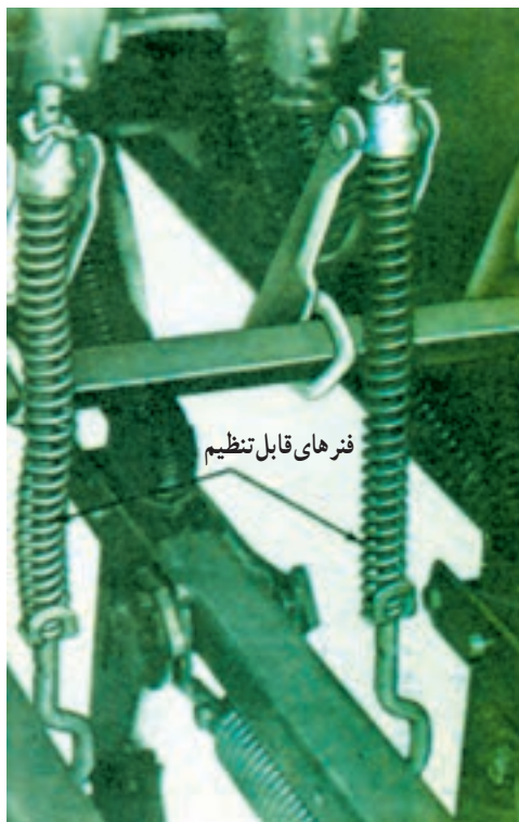
شکل ۱۶-۶- تنظیم عمق کاشت توسط فنر
