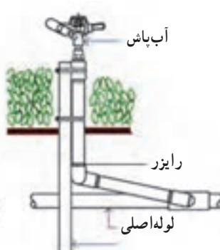
ب) آب‌پاش ضربه‌ای نصب شده روی رایزر
