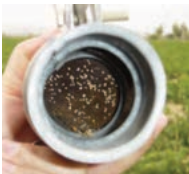
شکل ۱۸-۷- صافی (فیلتر) در مسیر لوله نیمه اصلی
