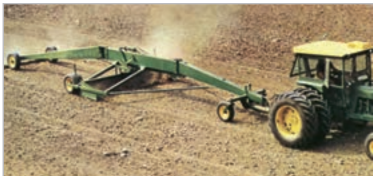
شکل ۲۷ - ۲ - تسطیح کن کششی سنگین حین کار
