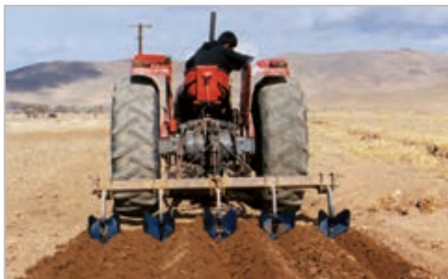
شکل ۳-۱- دستگاه شیارکش در حین کار
