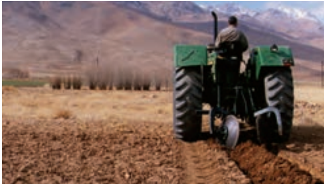
شکل ۳-۳ — مرکزکشی بشقابی در حین عملیات مرکزکشی
