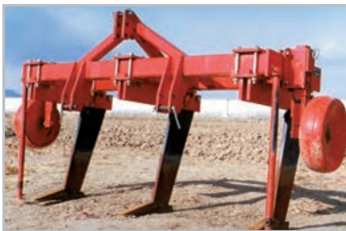
شکل ۱-۵- گاوآهن زیرشکن سوار
