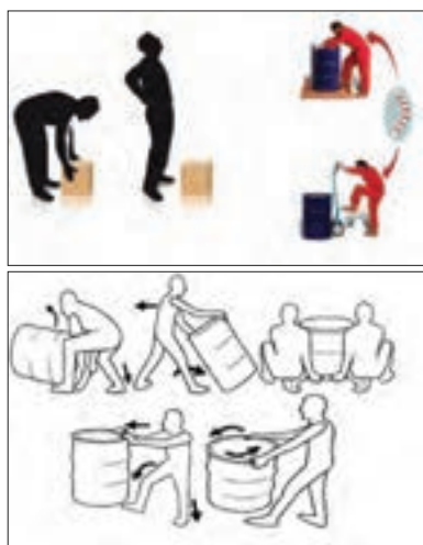
شکل ۲۵-۲- چگونگی جابه‌جایی اجسام سنگین برای پیشگیری از کمردرد
