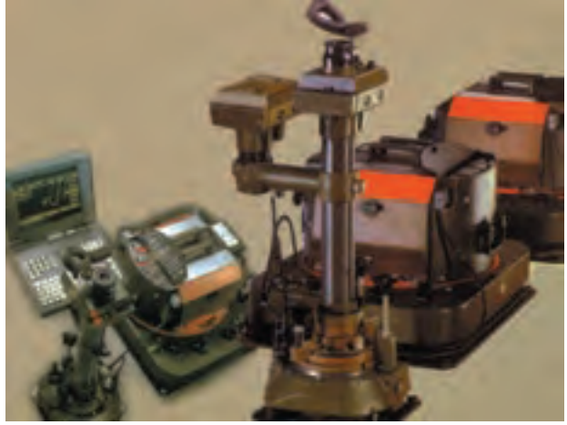
شکل ۹-۱- دوربین های جدید عکس برداری هوایی
