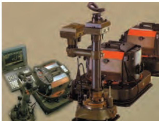
شکل ۹-۱- دوربین های جدید عکس برداری هوایی
