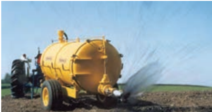
شکل ۱-۳۷- یک نوع کودپاش کود دامی مایع
