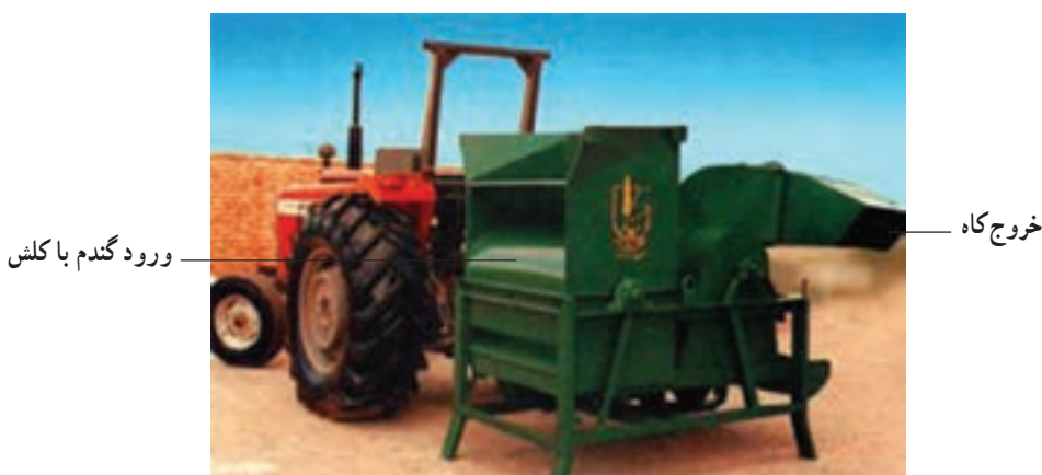
شکل ۱۷-۴- خرمنکوب متصل به تراکتور
