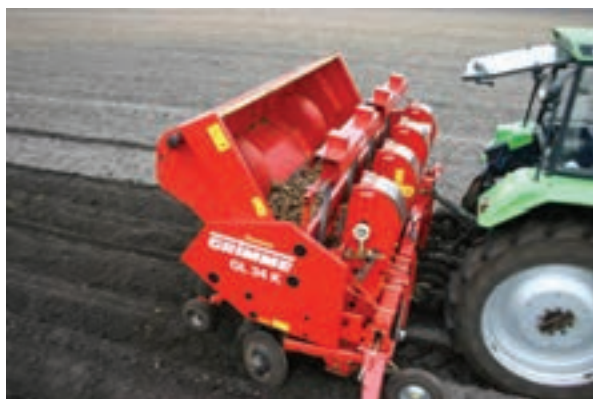
شکل ۱۷-۲- طرز کار یک نوع سیبزمینی کار خودکار
