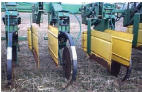
شکل ۳-۵ — سپرهای محافظ در پنجه مشخص هستند.
