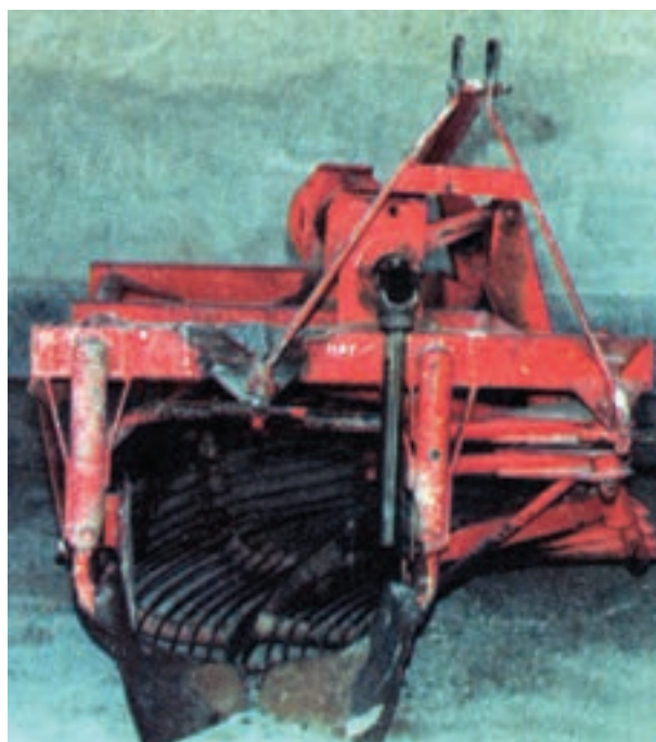
شکل ۲۱-۴- ماشین برداشت سیبزمینی با صفحه مشبک لرزان
