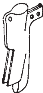
شکل ۶-۲- شیار بازکن کفشکی که برای اراضی خشک و خاک‌هایی که خوب تهیه شده‌اند، استفاده می‌شود.
