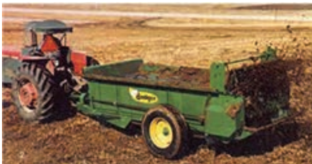
شکل ۳۸-۱- کودپاش کود دامی جامد در حین کار
