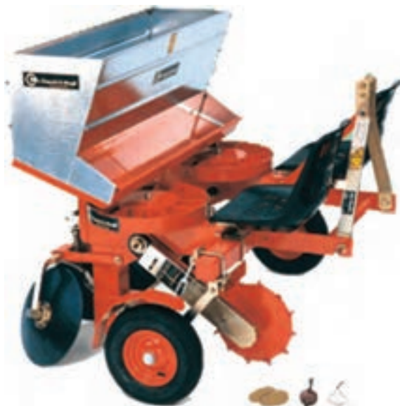
شکل ۱۵-۲- سیب‌زمینی کار نیمه خودکار
