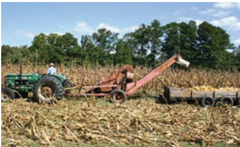
شکل ۴-۳۰ — یک ذرت چین کششی دو ردیفه با بستر پوست کن و پی نورد
