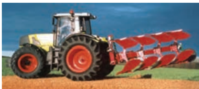
شکل ۱-۳ گاو آهن برگردان دار دو طرفه
