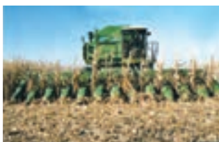
۱- ردیفکن ۲- زنجیر هدایت ۳- غلتک بلال چین ۴- استوانه ماریپیچی ۵- نقاله شکل ۱۹-۴- هد برداشت دزت دانه‌ای
