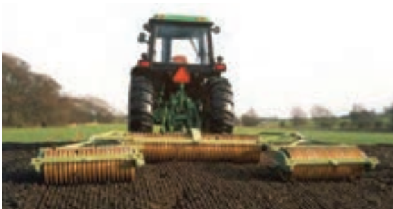
شکل ۳۴-۱ نحوه اتصال چند گروه غلتک حلقوی
