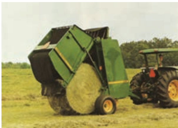
شکل ۱۴-۴- ماشین بسته‌بند استوانه‌ای
