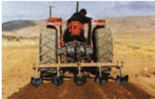
شکل ۴۵-۱- شیارکش نوع بیلچه ای
