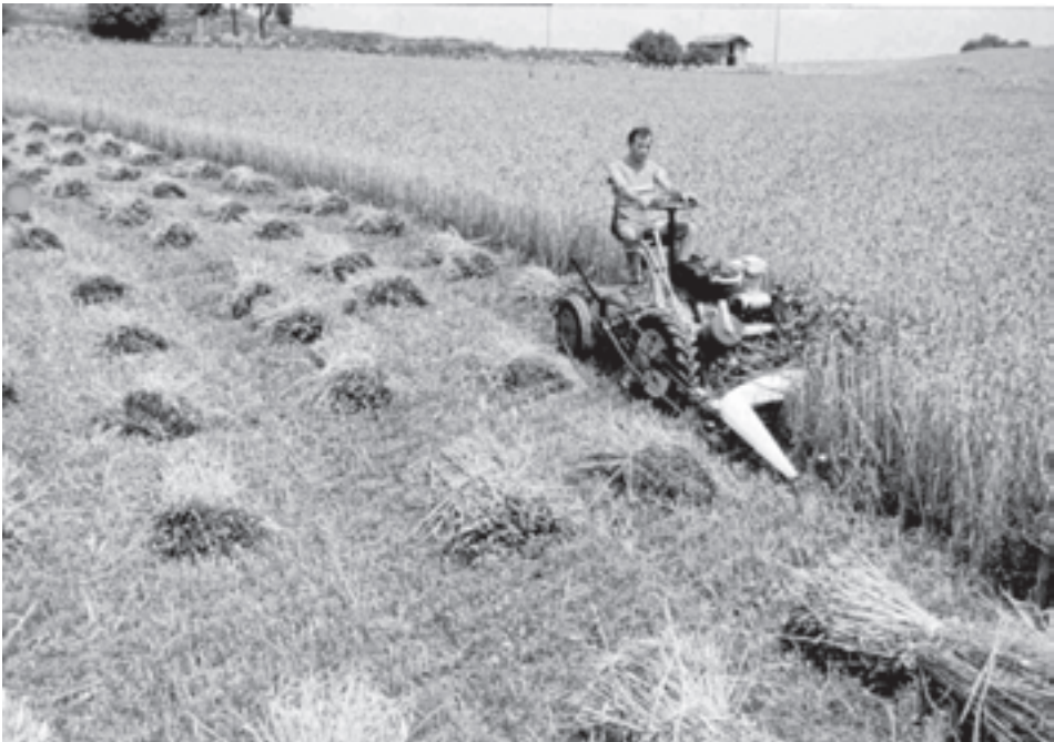
شکل ۴-۱۶- دروگر دسته‌بند در حین کار
