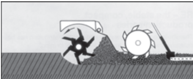
شکل ۲۳-۲- ماشین کمبینات (خاک‌ورزی کاشت توأم)
