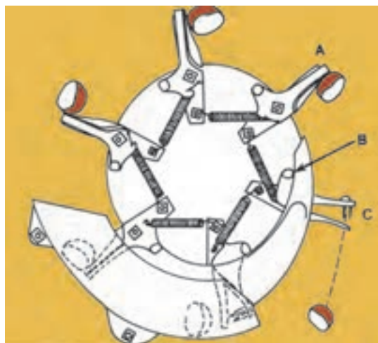
شکل ۱۸-۲- موزع سیبزمینی از نوع چنگک‌دار
