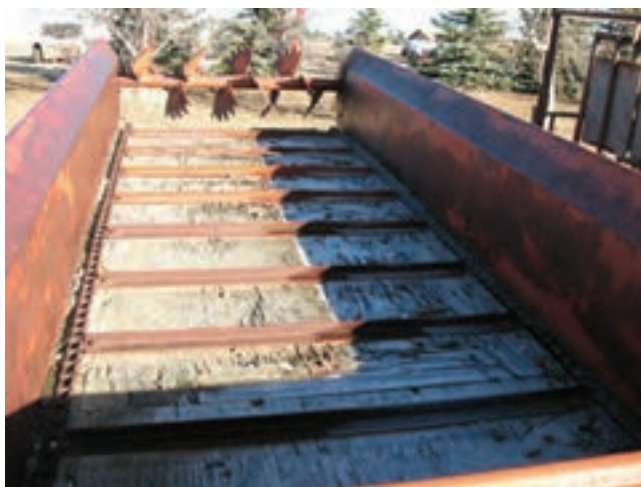
شکل ۳۹-۱- سیستم زنجیر نقاله در کف کودپاش کود دامی جامد
