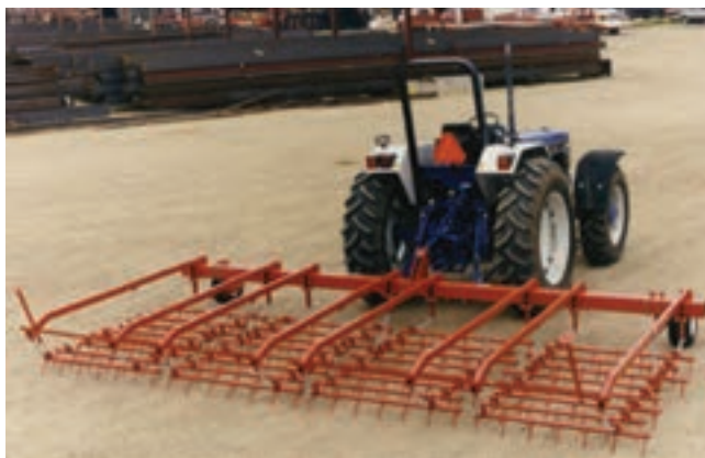
شکل ۱-۳۰ اتصال چند قاب به مالبند
