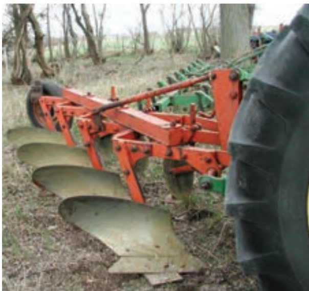
شکل ۱-۲- گاو آهن برگردان دار یک طرفه
