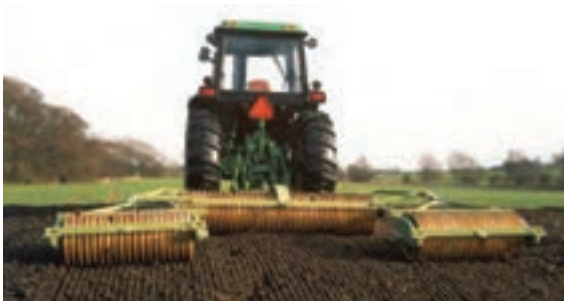
شکل ۳۴-۱ نحوه اتصال چند گروه غلتک حلقوی
