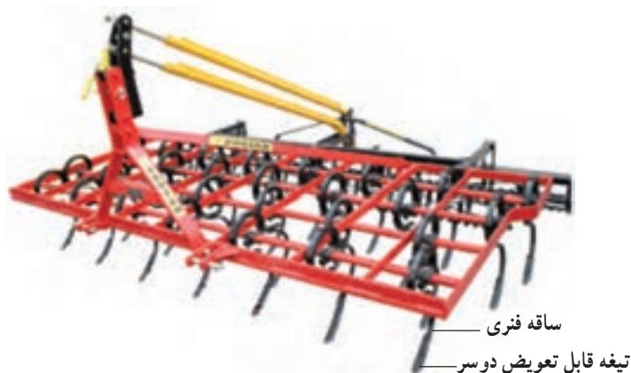
شکل ۲۸-۱- پنجه با ساقه فتری
