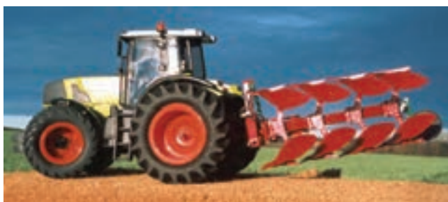
شکل ۱-۳- گاو آهن برگردان دار دو طرفه
