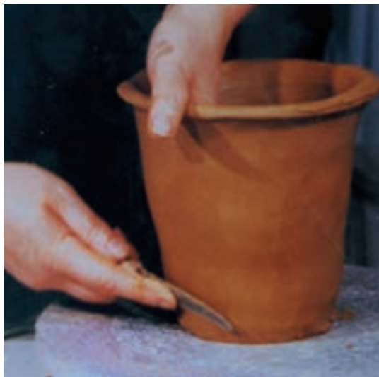
تصویر ۷-و - پرداخت کردن سطح خارجی حجم
