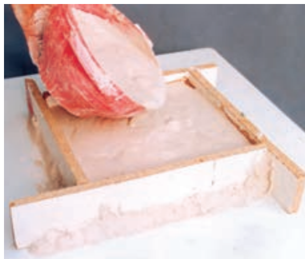
تصویر ۲- ج- ریختن دوغاب گچی روی نمونه
