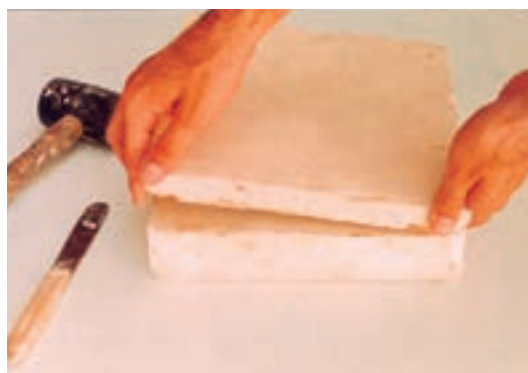
تصویر ۳-ج- برداشتن قالب از روی نمونه
