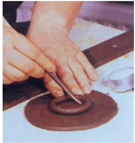
تصویر ۶-ب- ساختن پایه ظرف روی صفحه گلی
