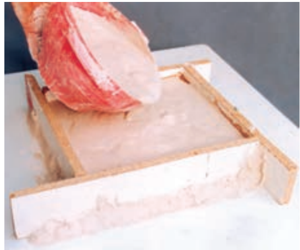
تصویر ۲- ج- ریختن دوغاب گچی روی نمونه
