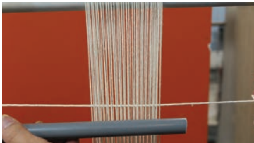
▲ تصویر ۳۰-۲ | قراردادن دوباره هاف در محل خود
