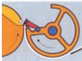
شکل ۱۲-۴- چرخه‌ی عملیات درام رنجر
