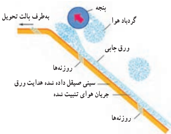
شکل ۳۸-۴- تثبیت ورق چاپی توسط سیستم هدایت هوا مجهز به روزنه‌های ونتوری
