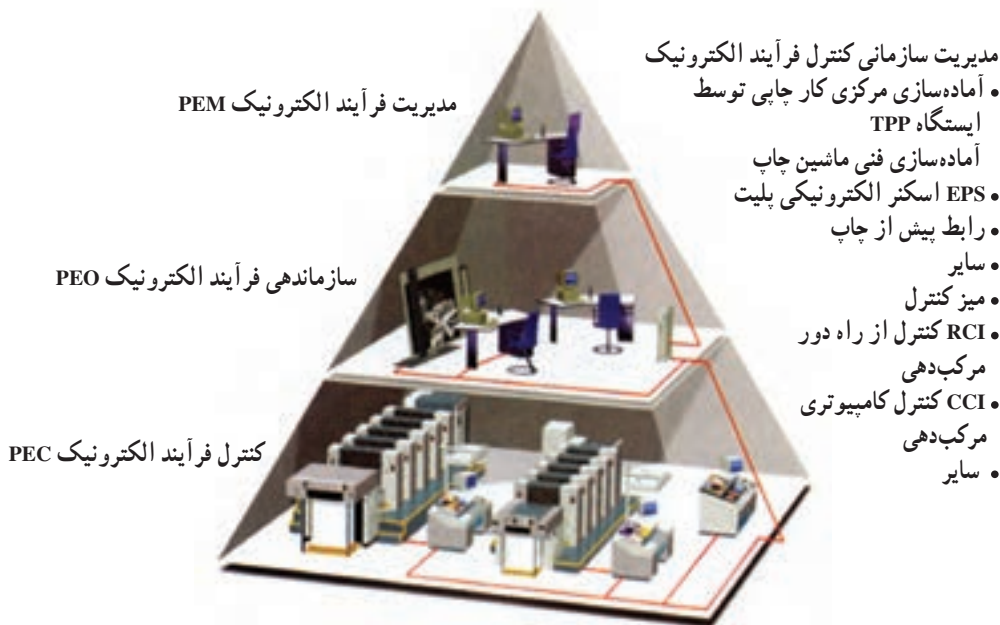
شکل ۲۳-۶- پ - سیستم PECOM (مان رولند)
