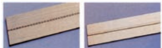
شکل ۷-۵- ورق‌های فلزی پرفراژی‌کاری، قابل نصب روی سیلندر لاستیک با نوارهای خط‌زنی و پرفراژ که روی ورق چسبانده می‌شوند.
