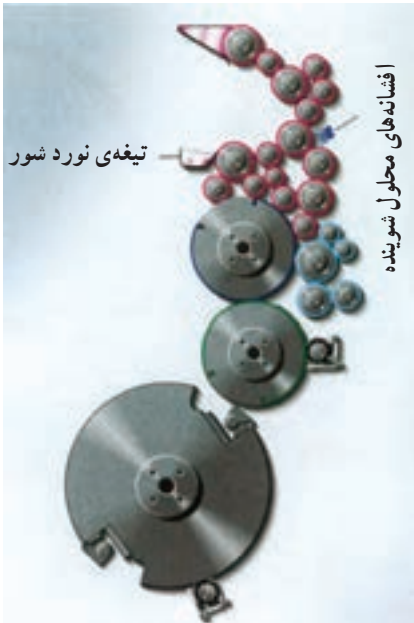
شکل ۶-۷ سیستم شست‌وشوی اتوماتیک نوردهای مرکب
