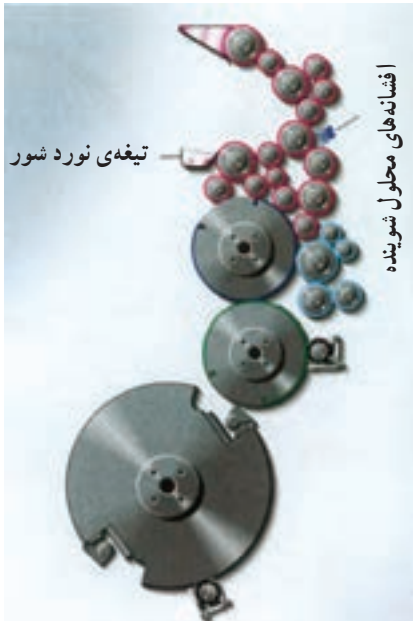
شکل ۶-۷ سیستم شست‌وشوی اتوماتیک نوردهای مرکب
