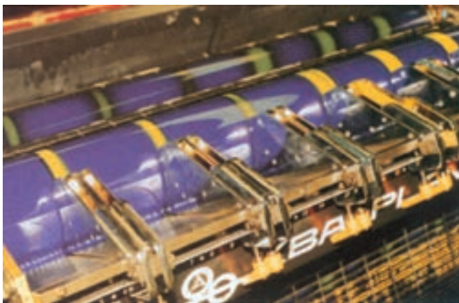
شکل ۱۳-۵- مرکب‌دان مجهز به جداکننده‌ها برای چاپ رنگ‌های متفاوت (چاپ رنگین‌کمانی) در یک واحد چاپ
