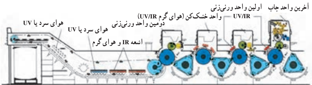
شکل ۳-۵- واحدهای ورنی زنی دوبل با واحد خشک‌کن، تحویل طولی و چندین مازول خشک‌کن
