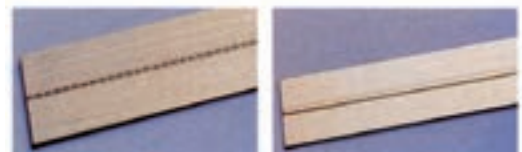
شکل ۷-۵- ورق‌های فلزی پرفراژی‌کاری، قابل نصب روی سیلندر لاستیک با نوارهای خط‌زنی و پرفراژ که روی ورق چسبانده می‌شوند.
