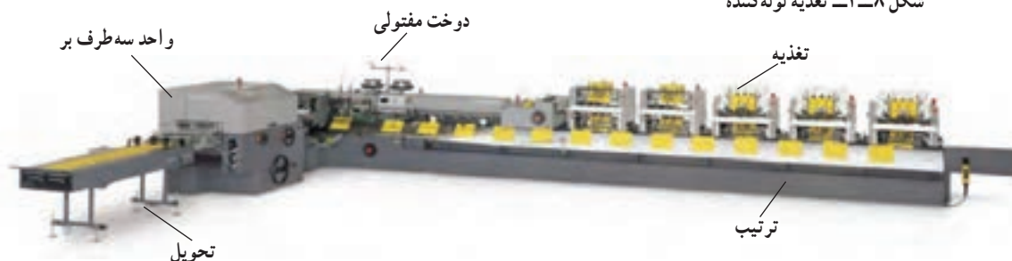
شکل ۹-۴- خط تولید مفتول دوزی، ترتیب - دوخت مفتولی
