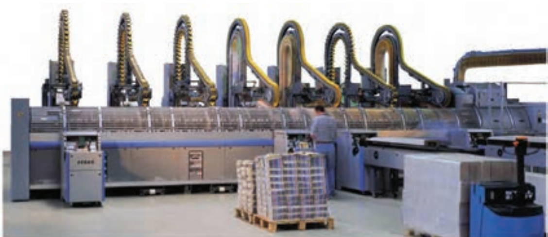
شکل ۴-۱۱- استوانه‌ی زینی دوخت مفتولی برای تولید مجله
