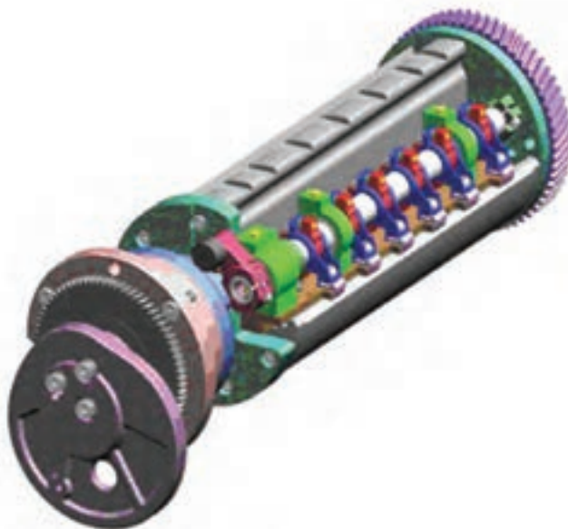
شکل ۲۳-۲- سیستم پنجه سیلندر فشار (چاپ) و اجزای تشکیل‌دهنده‌ی آن
