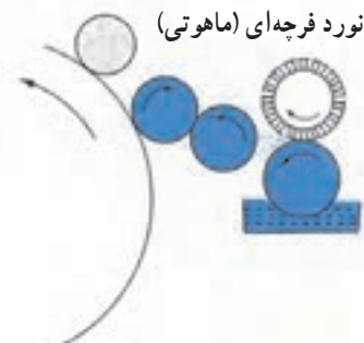
شکل ۲-۷- سیستم رطوبت‌دهی فرچه‌ای
