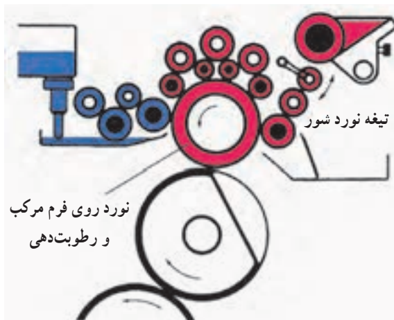
شکل ۱۰-۲- انتقال محلول رطوبت‌دهنده از طریق نورد مرکب
