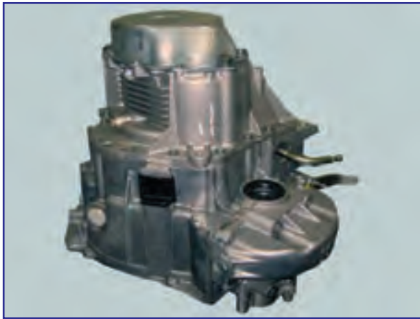
شکل ۳-۱- گیربکس دستی (BE4)
