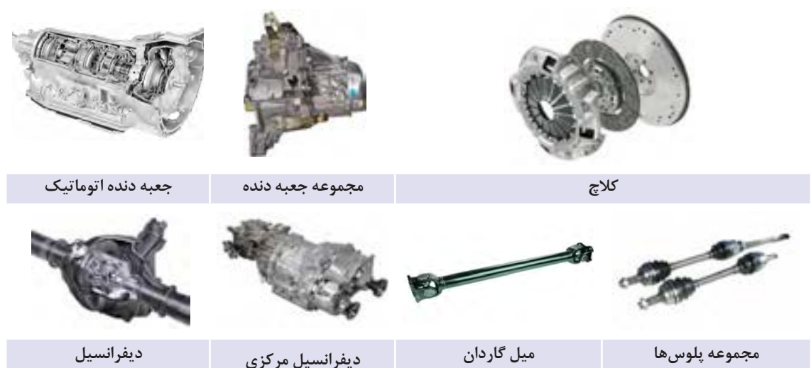
شکل ۱-۲۷- اجزای اصلی سیستم انتقال قدرت
