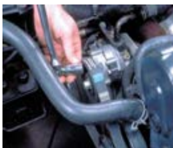
۹- پیچ تسمه سفت کن یا پولی آلترناتور سفت شود و عملکرد تسمه بررسی شود.
