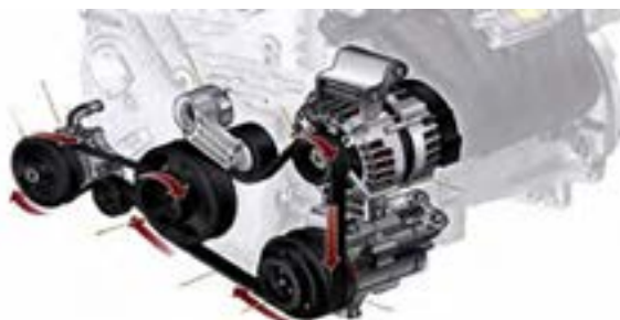
شکل ۴-۲- اجزای سیستم انتقال توان به کمک تسمه و پولی
