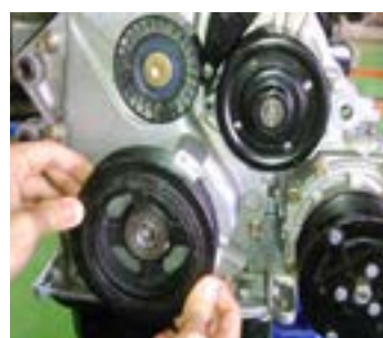
۱- پولی سرمیل لنگ و تسمه سفت کن نصب شود.
