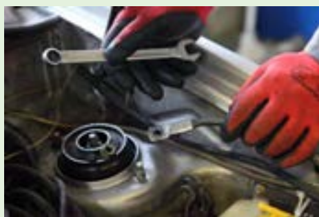
شکل ۳۳-۱- جداکردن اتصالات منفی بدنه
