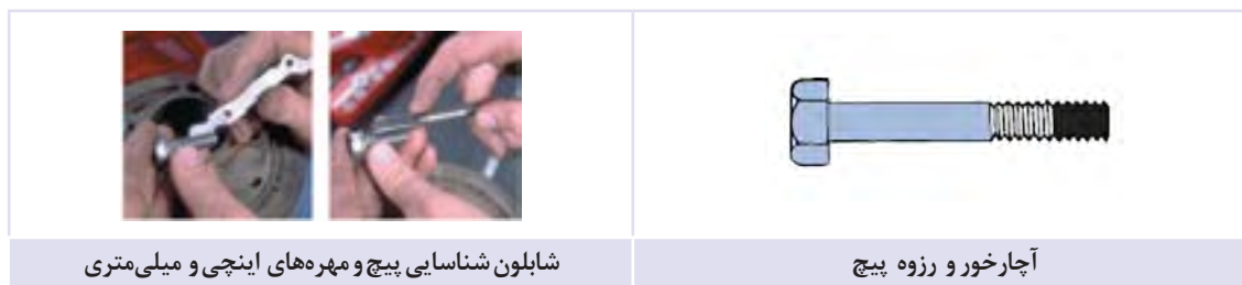
شکل ۱۳-۱ - شناسایی رزوه پیچ
