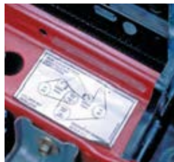
۴- به نحوه قرارگیری تسمه بر روی پولی ها و هرزگردها توجه شود.
