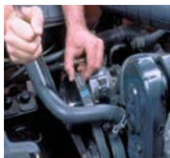
۶- تسمه سفت کن یا پولی آلترناتور شل شود.
