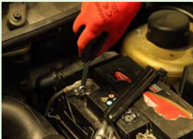
شکل ۱۹-۲- جدا کردن سر باتری
