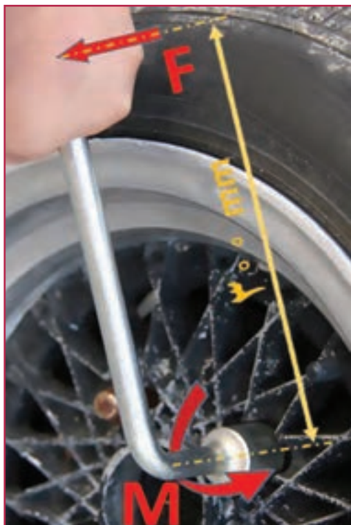
شکل ۱۰-۴- باز کردن پیچ چرخ خودرو توسط آچار چرخ
