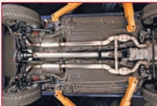
شکل ۴-۳۰- میل گاردان بارگذاری پیچشی را برای انتقال گشتاور تحمل می نماید
