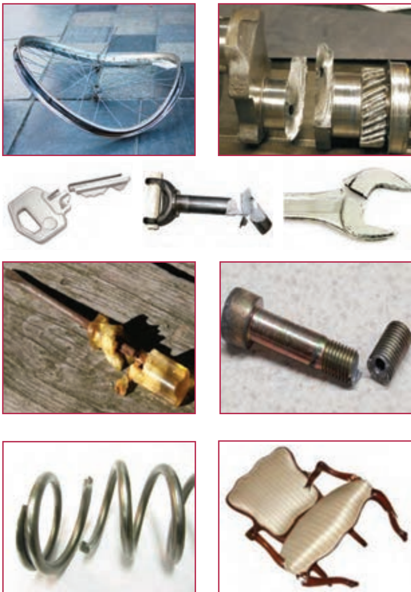
شکل ۱-۴- نمونه‌هایی از شکست قطعات
