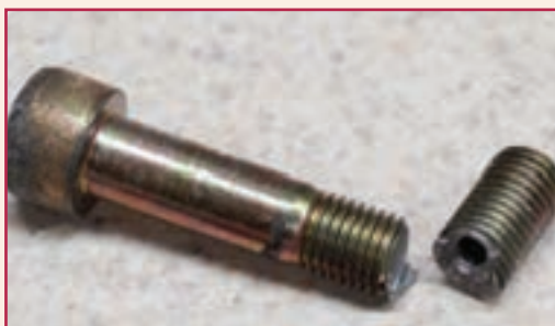
شکل ۴-۲۹- یک پیچ بریده شده بر اثر بارگذاری پیچشی
