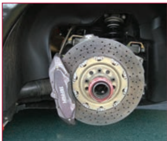
شکل ۲-۲- دیسک ترمز سرامیکی
