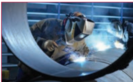
شکل ۵-۱- جوش کاری مخزن فولادی
