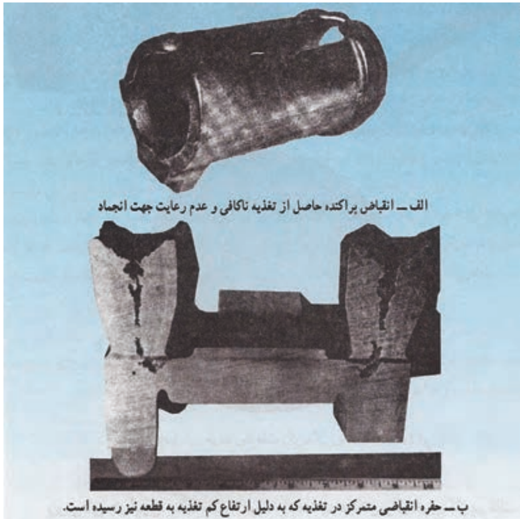
شکل ۲-۱۸- کشیدگی و حفره های انقباضی
