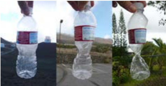
شکل ۵-۶- بطری خالی پلمب شده در ارتفاع ۳۰۰ و ۲۷۰۰ و ۴۳۰۰ متری از سطح دریا
