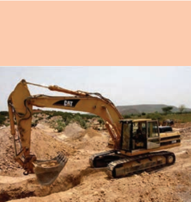
شکل ۱۴-۶- نوعی ماشین ترانشه‌زنی
