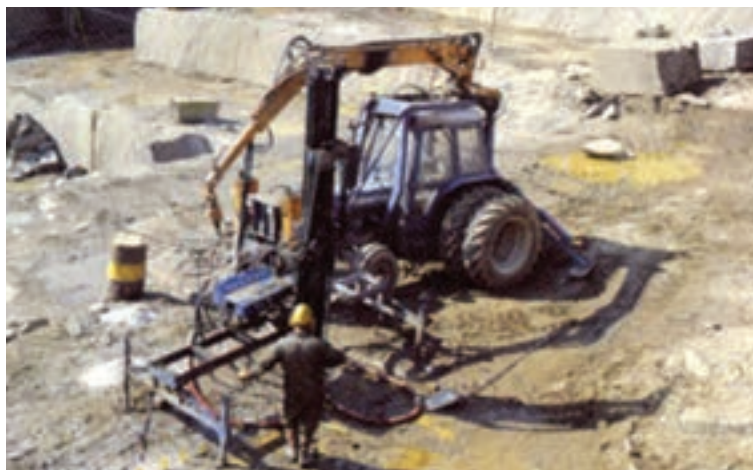
شکل ۱-۱۵- کاربرد تراکتور در معدن روباز
