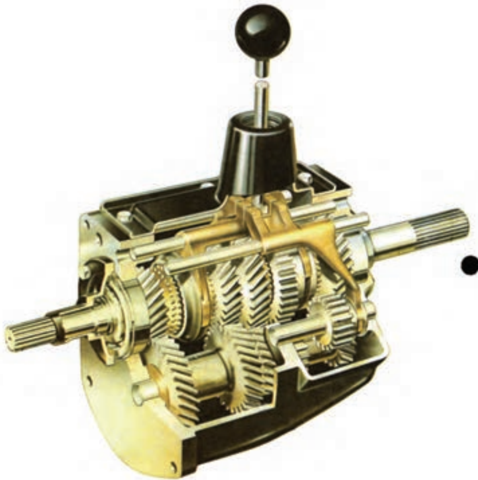
شکل ۱-۳- نمای برش خورده از یک گیربکس
