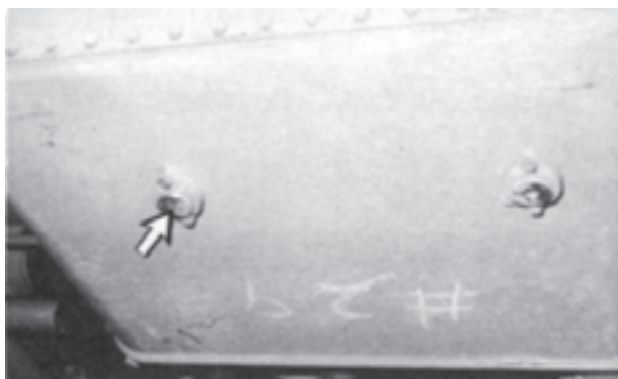
شکل ۱۸-۶- پیچ تخلیه مخزن هیدرولیک
