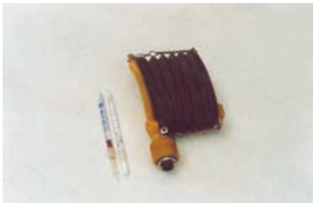
شکل ۱۱-۷ اجزای دستگاه گازسنج
