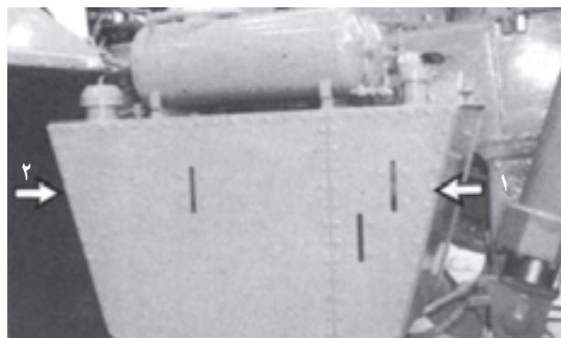
شکل ۲۹-۶ مخزن روغن هیدرولیک
