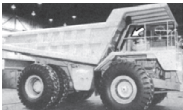
شکل ۳۰-۶ محل مخزن روغن سیستم فرمان
