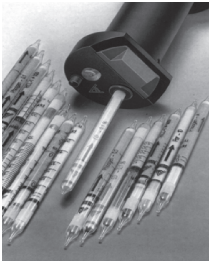
شکل ۱۷-۷. انواع کیسول‌های اندازه‌گیری جهت گازهای مختلف معدن
