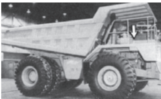
شکل ۲۷-۶ اندازه‌گیری سطح روغن
