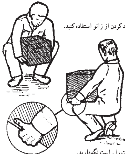
شکل ب - طرز بلند کردن بار
