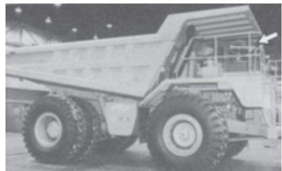
شکل ۳۷-۶- بررسی وضعیت اسکلت اتاق راننده
