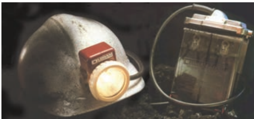
شکل ۷-۱۰- طریقه استفاده از چراغ الکتریکی کلاهی
