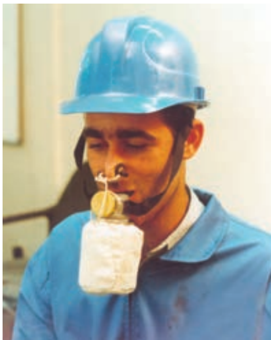
شکل ۱۱-۱- قراردادن گیره بینی روی بینی و آماده کردن دستگاه خودنجات
