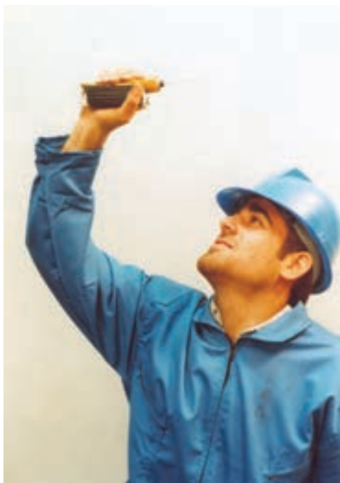
شکل ۱۵-۷ فشار دادن دستگاه برای جذب هوا
