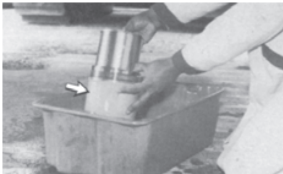
شکل ۸۰-۶- بستن واشر آب بندی فیلتر نو
