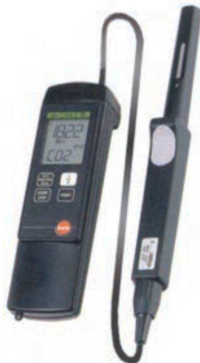
الف — گازسنج دی اکسید کربن \text{CO}_2
