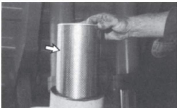
شکل ۷۸-۶- قرار دادن صافی تمیز در مخزن
