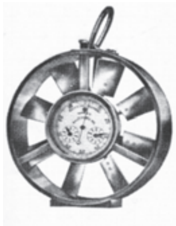
شکل ۳-۱-۸- هواسنج پره‌دار
