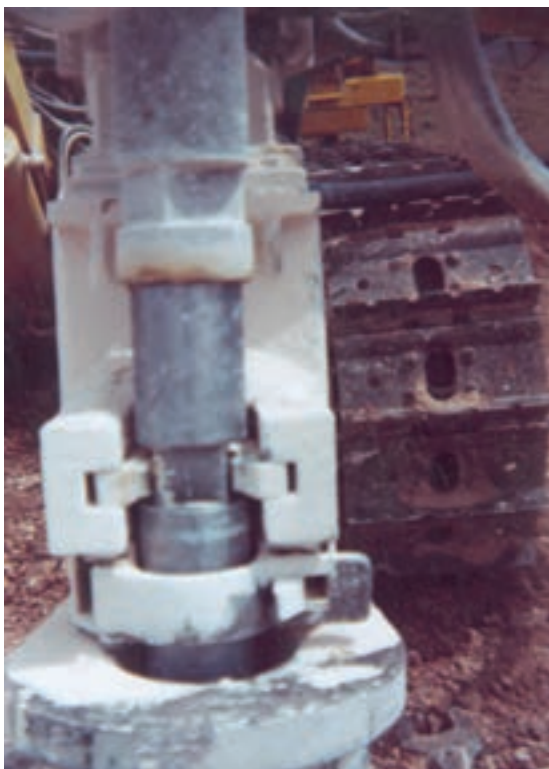
ب- حالت درگیر آچار راد بازکن
