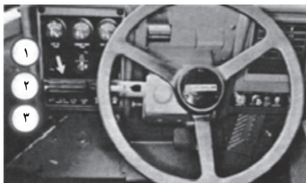
شکل ۲۵-۴ — اهرم گیربکس (دسته دنده)
