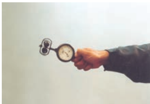
شکل ۸-۹ - طرز گرفتن هواسنج در مسیر جریان هوا
