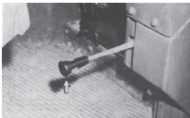
شکل ۱۹-۵- ترمز دستی ترمز دستی: اهرم ترمز دستی علاوه بر درگیر کردن ترمز،
