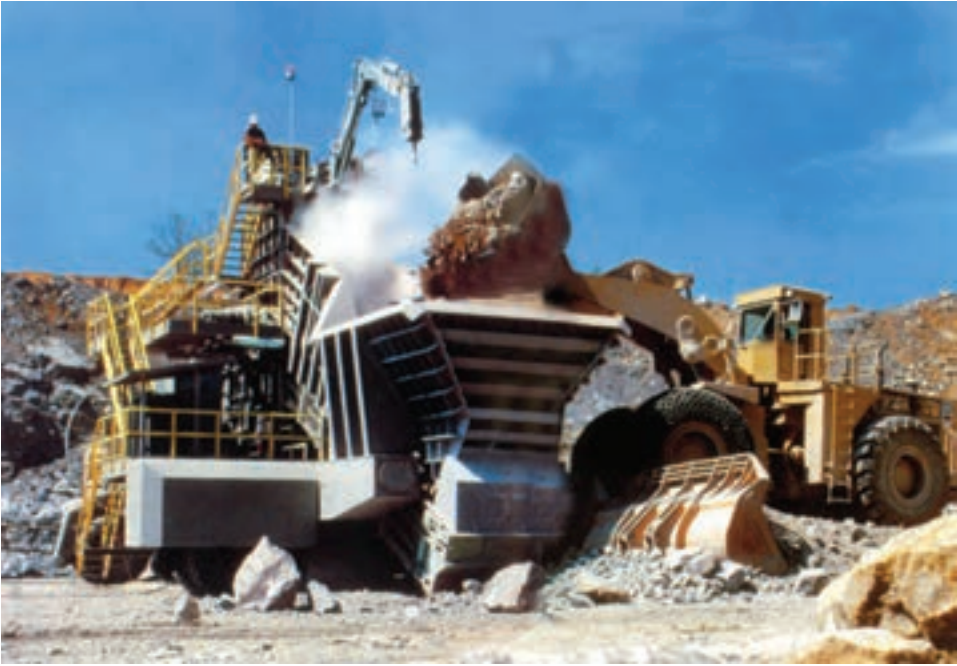
شکل ۱۷-۴- لودر در حال بارگیری سنگ شکن معدن
