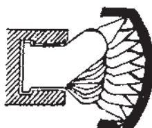
شکل ۲-۹- مکانیزم متحرک زنجیر و نحوه ایجاد شیار
