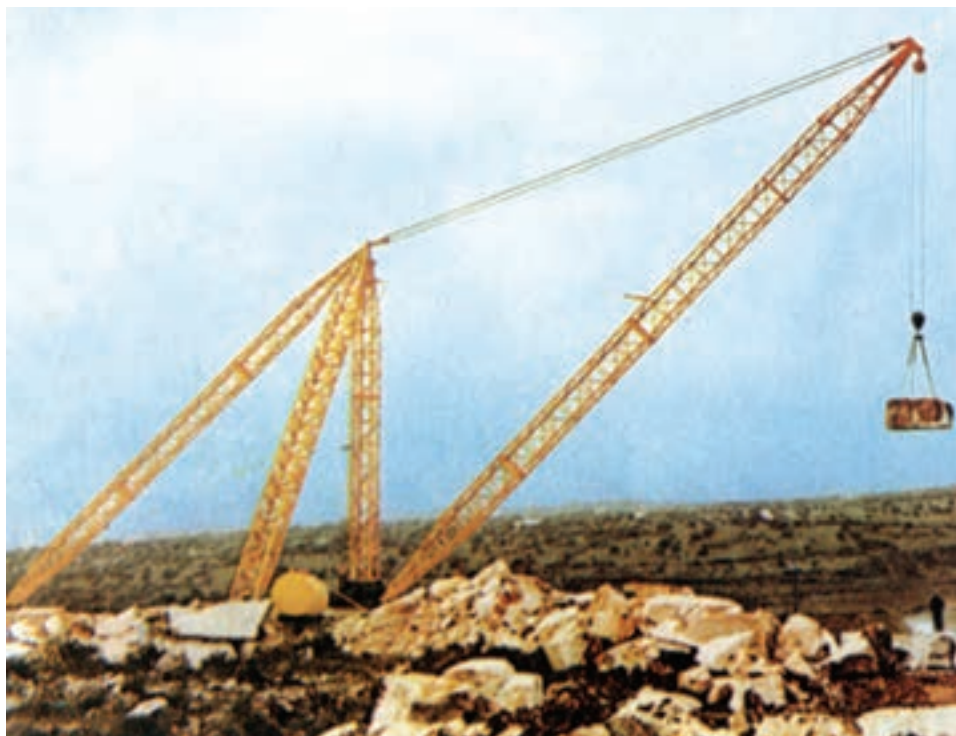
شکل ۲۲-۵- جرثقیل مخصوص حمل بلوک‌های سنگ استخراجی
