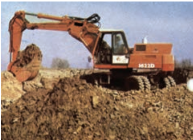
شکل ۲۰-۴- بیل مکانیکی چرخ لاستیکی با جام معکوس
