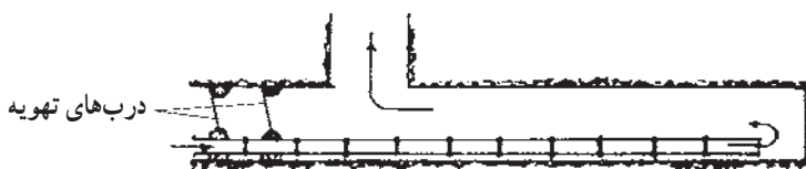
شکل ۲-۴۳- کاربرد صندوقه در تهویه
