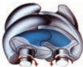
شکل ۱۰-۶- اصول کار کمپرسور پیچی
