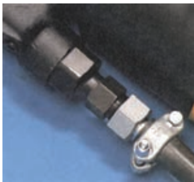
ه - کوپلینگ پیچی و شیلنگ با یک بست اتصال
