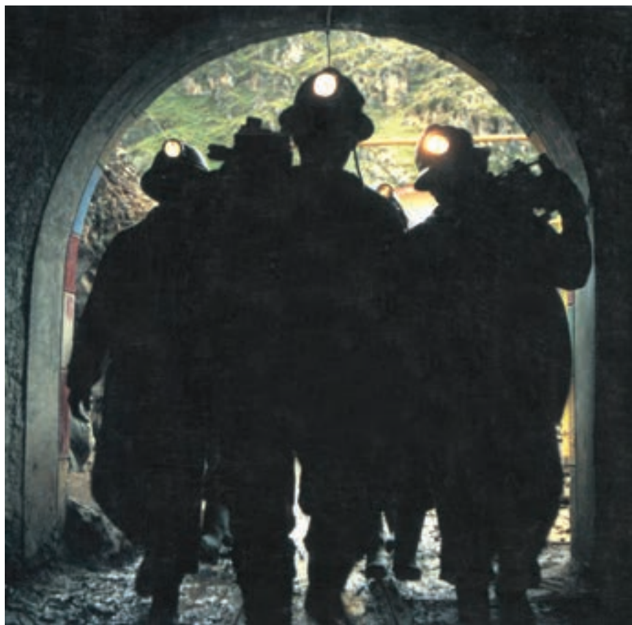
شکل ۴-۴- چراغ‌های انفرادی که نورافکن آن قابل نصب بر روی کلاه است و باتری آن به کمر نصب می‌شود.
