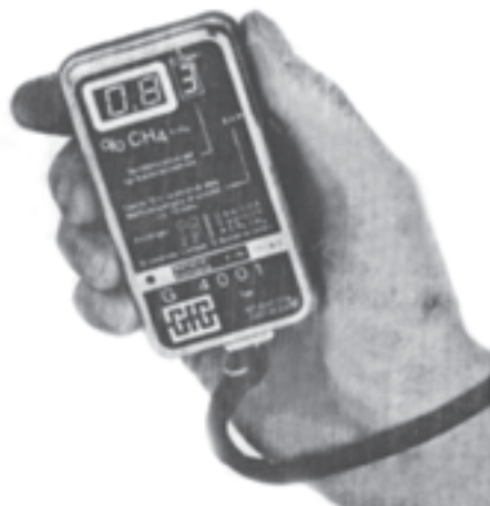
شکل ۹-۱- دستگاه گازسنج متان از نوع مقاومتی
