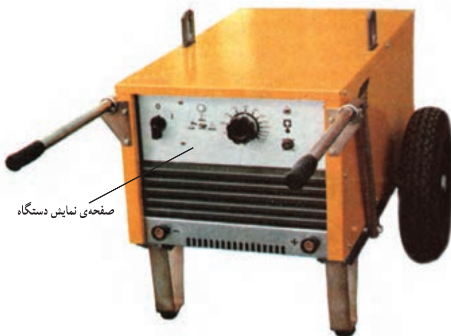
شکل ۹- دستگاه جوش با استفاده از برق شهر، همراه با کلید انتخاب آمپر
