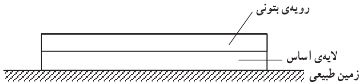
شکل ۱۱-۱ - روسازی صلب با استفاده از لایه‌ی اساس
