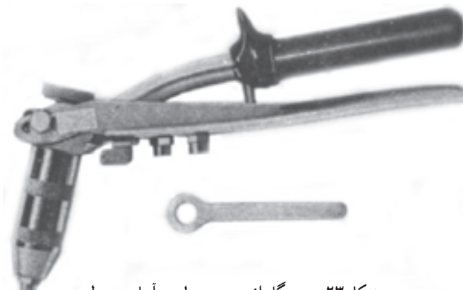
شکل ۲۳- دستگاه انبرپرچ معمولی و آچار مربوطه
