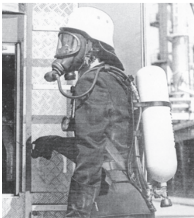
شکل ۱۱-۲- دستگاه تنفس انفرادی دارای کپسول هوای فشرده با ماسک صورت کامل
