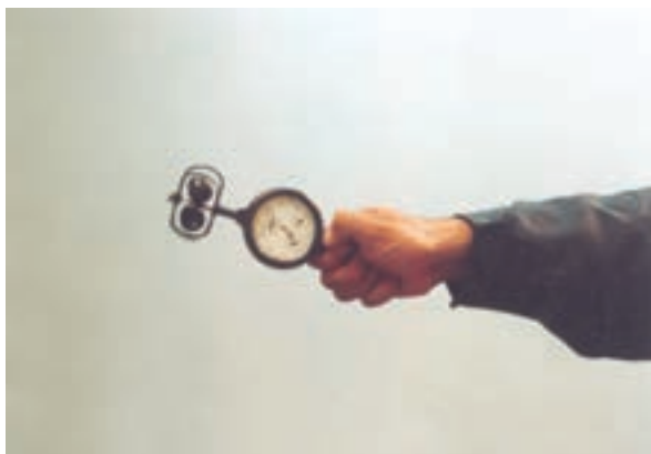
شکل ۸-۹ - طرز گرفتن هواسنج در مسیر جریان هوا
