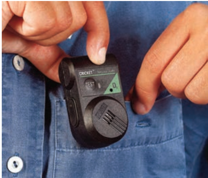
۶-۷. نحوه نصب دستگاه هشداردهنده بر روی لباس کار
