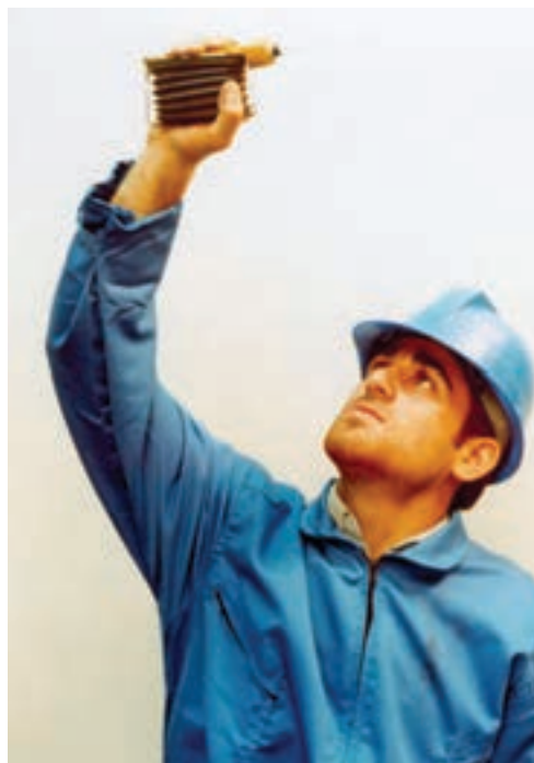
شکل ۱۴-۷ قرار دادن دستگاه در مسیر جریان هوای داخل معدن
