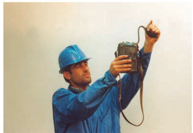
شکل ۸-۷- فشردن تلمبه لاستیکی و انتقال هوا به داخل اینترفرومتر
