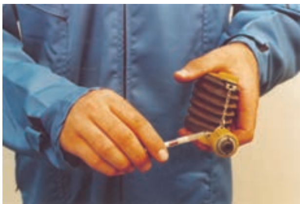
شکل ۱۲-۷- شکستن دو قسمت سر آمپول توسط زائنده دستگاه
