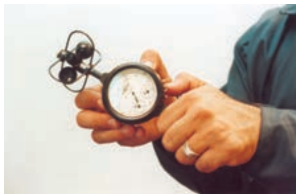
شکل ۱۰-۸ - قفل کردن عقربه توسط اهرم برای مدت یک دقیقه
