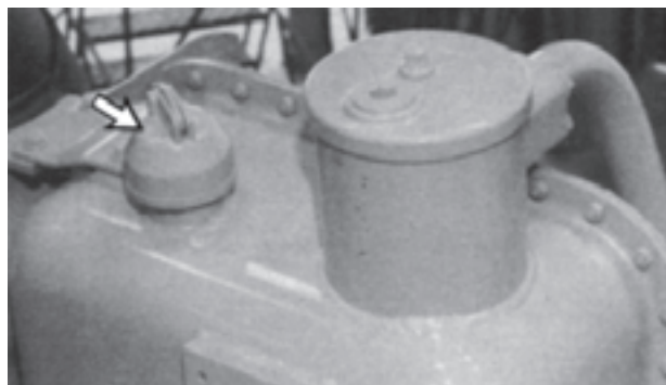
شکل ۹۱-۶ - پر کردن سیستم هیدرولیک فرمان از روغن
