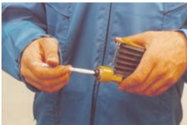
شکل ۱۳-۷- قرار دادن آمپول در داخل دستگاه ۱۴۳
