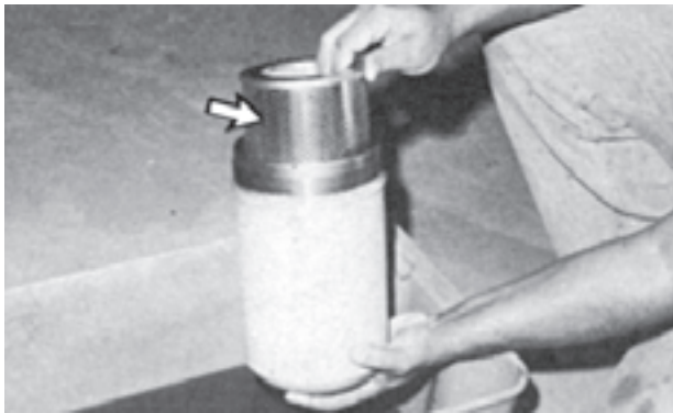
شکل ۷۷-۶- واشر آب‌بندی پایه فیلتر
