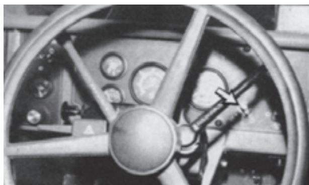
شکل ۶-۴۶- بررسی و کنترل ترمز ثانویه
