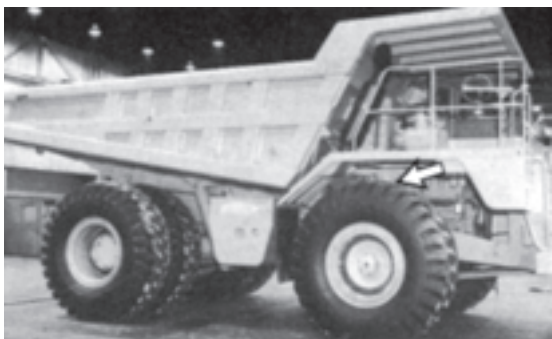
شکل ۳۶-۶- بررسی وضعیت سیلندرهای تعلیق، شارژ سیلندرها
