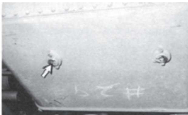
شکل ۱۸-۶- پیچ تخلیه مخزن هیدرولیک
