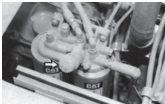
شکل ۱-۷۰-۶- هواگیری سیستم سوخت
