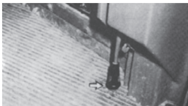
شکل ۱۹-۵- ترمز دستی ترمز دستی: اهرم ترمز دستی علاوه بر درگیر کردن ترمز،
