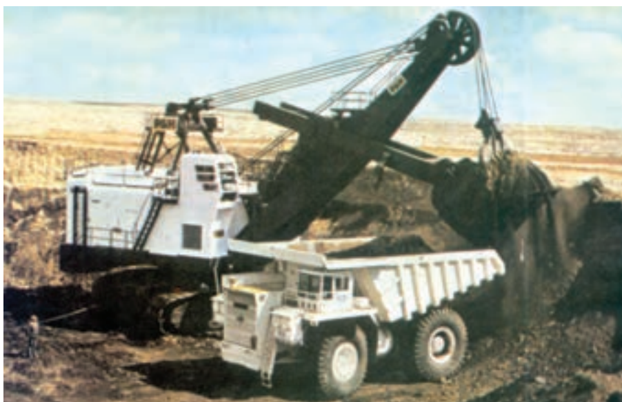
شکل ۲۴-۴- بیل کابلی در حال کار
