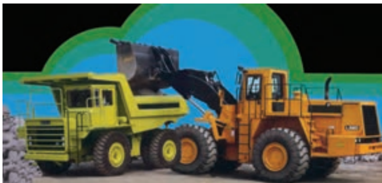
شکل ۲۴-۲- لودر در حال بارگیری
