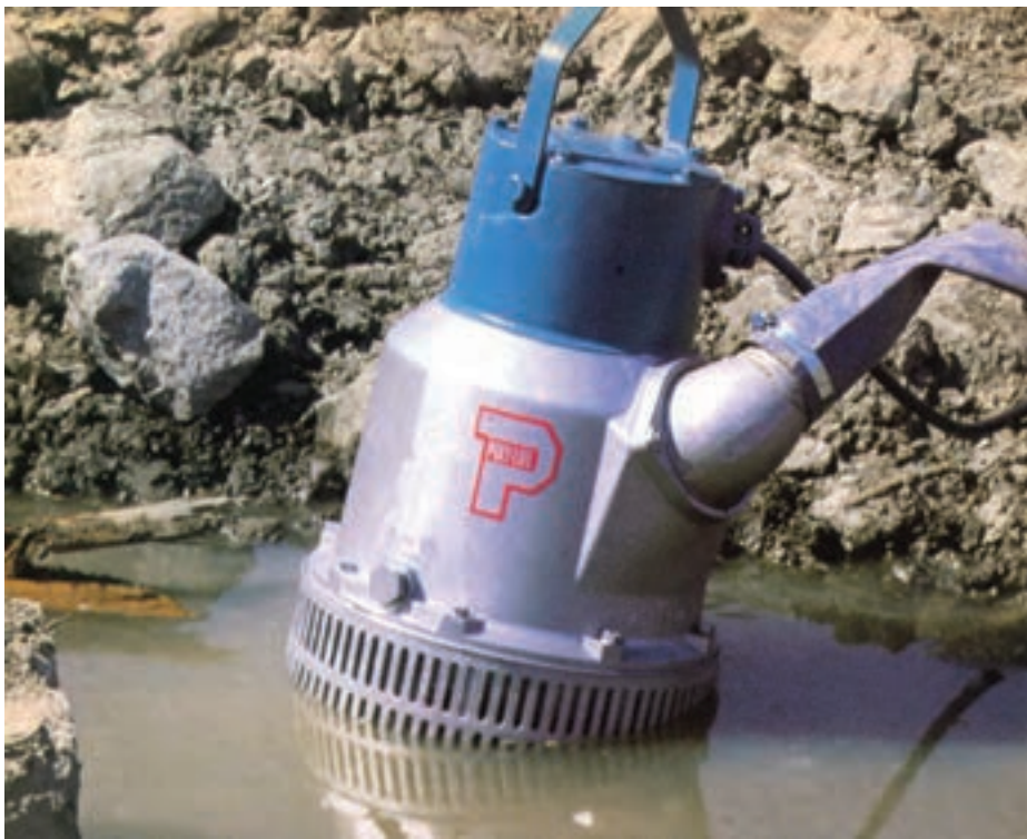
شکل ۱۶-۲- پمپ آبکشی در حال پمپاژ آب سطحی
