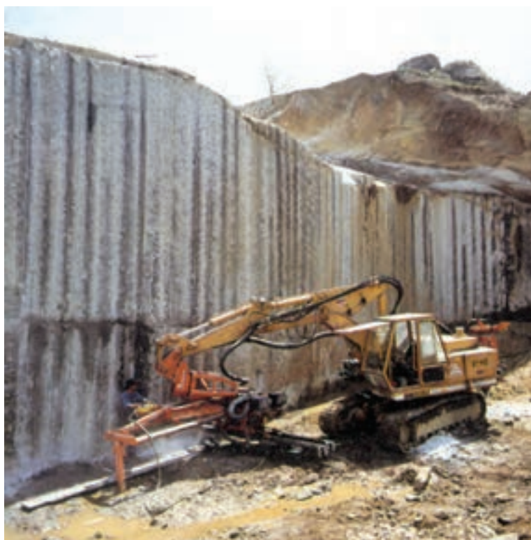
شکل ۴-۱- استخراج در یک معدن سنگ ساختمانی
