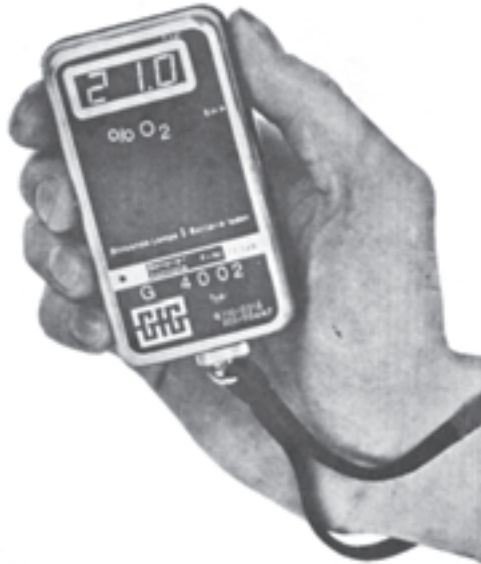
شکل ۱-۱- دستگاه اندازه‌گیری دیجیتالی اکسیژن
