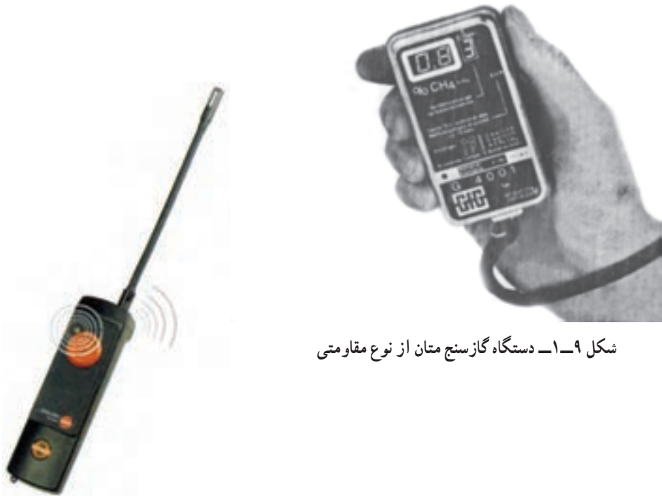
شکل ۱۰-۱- نوعی دستگاه متانومتر دستی
