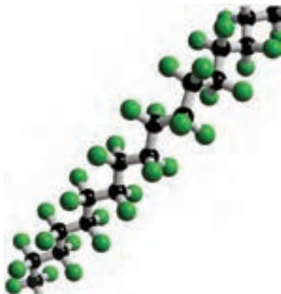
شکل ۲-۱۷- بخشی از یک مولکول پلیمری (تفلون)
