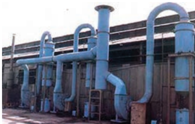
شکل ۳-۳۵- سیستم سایش نیوماتیکی برای احیای ماسه به روش خشک
