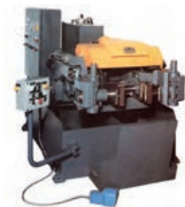
شکل ۳-۲۱- ماشین ریخته‌گری ریژه تمام اتوماتیک
