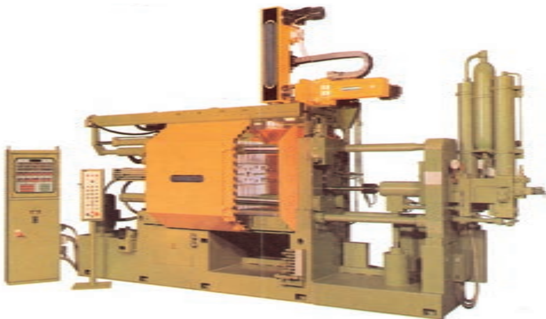
شکل ۲۶-۳ ماشین ریخته‌گری تحت فشار با محفظه سرد
