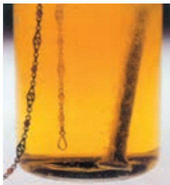
شکل ۱-۴- واکنش فلز روی (میخ شکل) با هیدروکلریک اسید و ایجاد گاز هیدروژن و واکنش نداشتن زنجیر طلا با هیدروکلریک اسید
