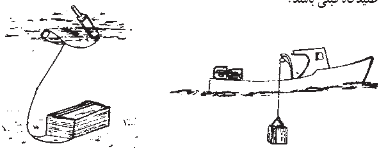
شکل ۴-۷- نصب قفس به صورت منفرد و نحوه بالا کشیدن آن با استفاده از وینچ
