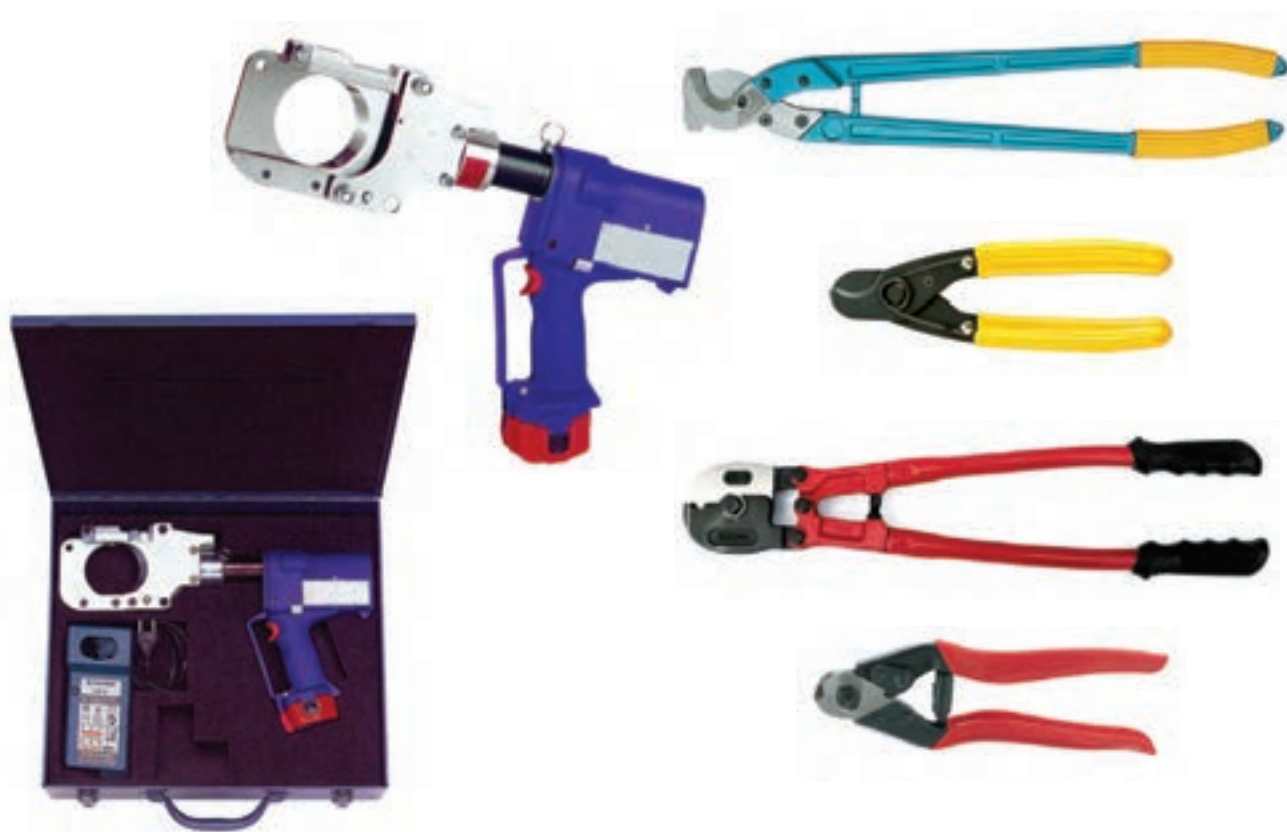
شکل ۱۸-۳ انواع قیچی‌های کابل‌بری
