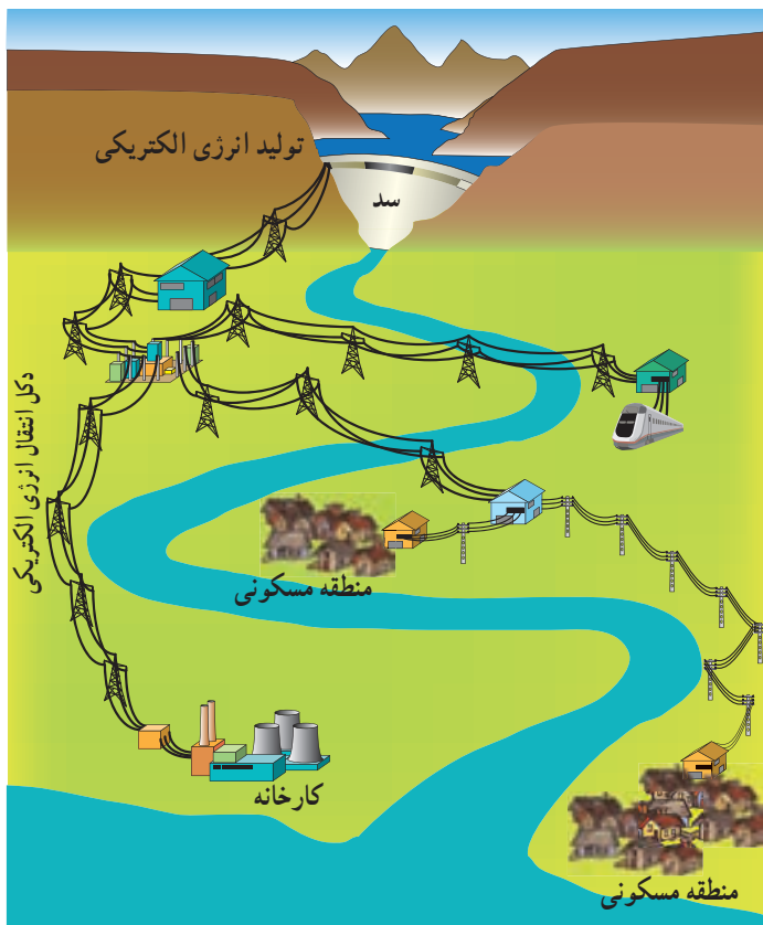
شکل ۱-۱ توزیع انرژی الکتریکی تولید شده به وسیله‌ی سد
