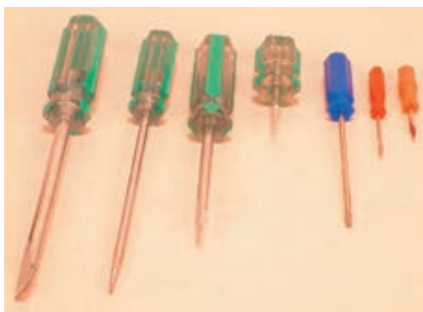
شکل ۳-۱ انواع پیچ گوشتی‌های تخت
