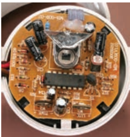
شکل ۵-۴۲ اجزای داخلی (PIR)
