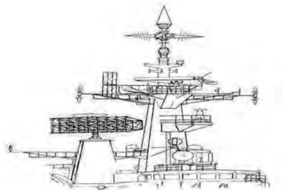
شکل ۱۲-۴ دکل کشتی مجهز به انواع آنتن دستگاه‌های الکترونیکی
