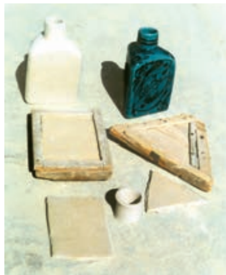
تصویر ۶ - شکل‌دهی به وسیله قالب چوبی - کارگاه بهاری - شهرضا
