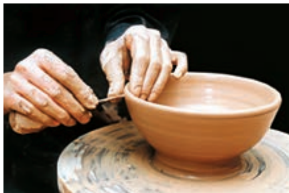
تصویر ۲۲- بریدن لبه کاسه با ابزار برش
