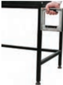
شکل ۲-۲- کنترل شیب پایه‌ی میز
