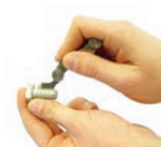
شکل ۱۰-۸- تعیین گام پیچ
