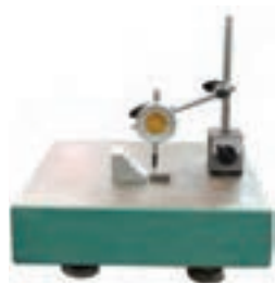
شکل ۲-۸- اندازه‌گیری قطعه‌ی پله‌ای
