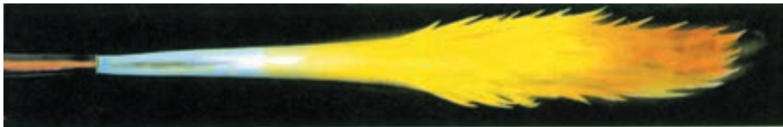
الف سوختن استیلن در آتمسفر شیر گاز را باز کنید تا شعله دود کند.
