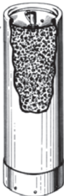
شکل ۵-۲- نمای داخل کپسول استیلن
