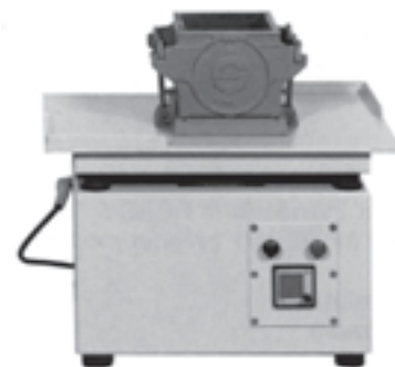
میز لرزان برای متراکم کردن نمونه‌های آزمایشی
