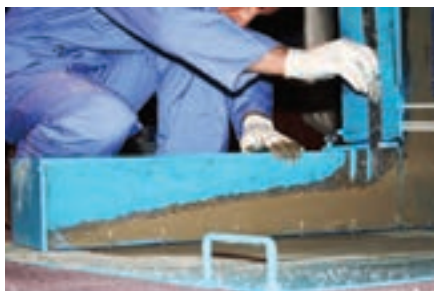
شکل ۴- نمونه‌ی اجرای آزمایشگاهی بتن خود تراکم
