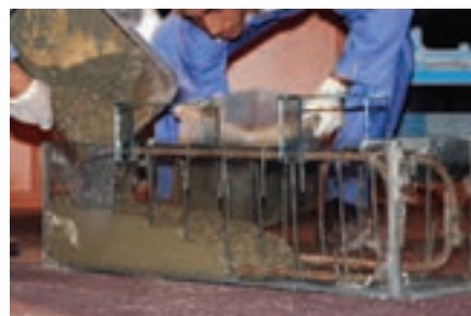
شکل ۴- نمونه‌ی اجرای آزمایشگاهی بتن خود تراکم
