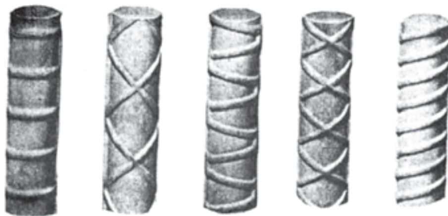
شکل ۴-۱- سطح ظاهری میلگردهای آجدار
