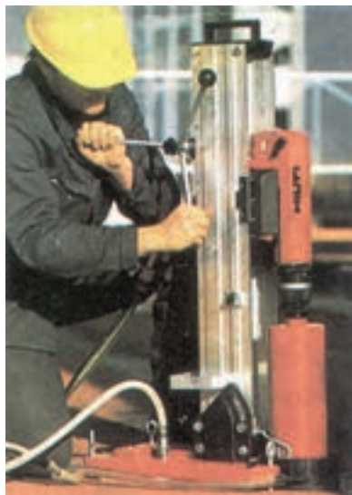
شکل ۲-۱۱- دستگاه مغزه‌گیری
